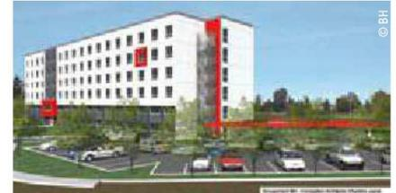
la conception modulaire des bâtiments, le procédé choisi par le Crous pour gagner en efficacité, en rapidité et en coût. Les modules sont préfabriqués en atelier avant d'être installés sur site. Cette approche industrielle de la construction permet notamment de gagner six mois de travaux.
